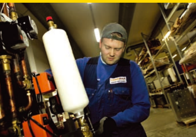
Jukka Virtanen testaa maalämpöpumpun liitokset ennen loppukokoonpanoa.
